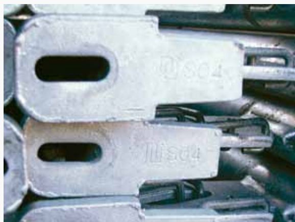
Exempel på märkning av balk eller räcke i höghållfast stål.
