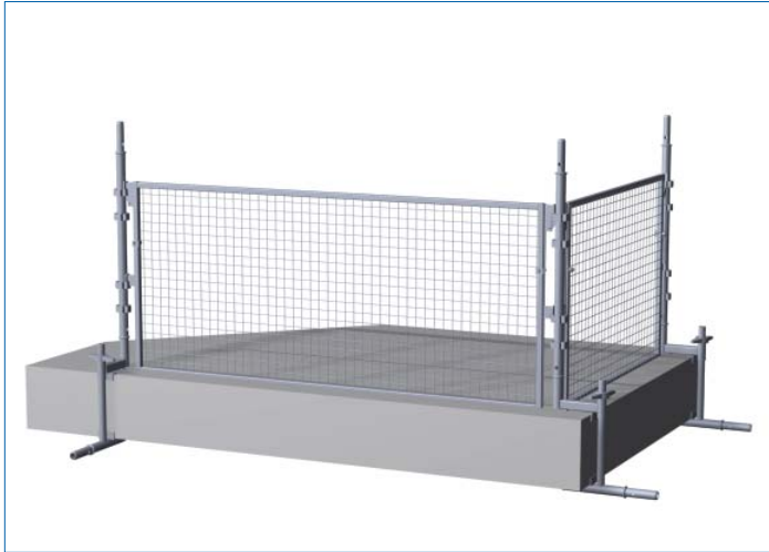
Valvkant med universalfäste, spira och skyddsgrind med nät
